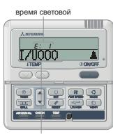
■ Кондиционер останавливается в случае возникновения неполадки. В это же время световой индикатор проверки мигает красным, в зоне дисплея показывается код ошибки, а на дисплее сообщений отображается следующее.
