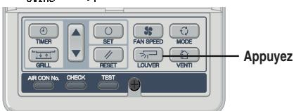
Lorsque la position du volet mobile est sélectionnée
