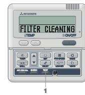
Meldung „FILTER CLEANING“ wird angezeigt, wenn die Anzahl der Betriebsstunden eine festgesetzte Stundenanzahl erreicht hat, zu der Sie über die erforderliche Filterreinigung benachrichtigt werden.
