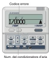
Il condizionatore d'aria smette di funzionare se si verifica un errore. Contemporaneamente lampeggia la spia di controllo di colore rosso, un codice errore viene visualizzato sull'area display del timer, e sul display vengono visualizzati i seguenti messaggi.
