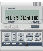
É mostrado "FILTER CLEANING" quando o tempo acumulativo de funcionamento atinge o número de horas, de forma a avisar que é necessária uma limpeza.
