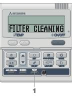
Sul display viene visualizzato "FILTER CLEANING" se la somma delle ore di funzionamento dell'unità interna raggiunge il numero di ore per il quale è stato impostato un messaggio di notifica di pulizia dei filtri.
