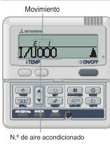
El aire acondicionado se detiene en el caso de que ocurra cualquier problema. Al mismo tiempo el indicador de comprobación parpadea en rojo y el código de error se muestra en la pantalla temporizador ON (encendido) y la pantalla muestra lo siguiente.
