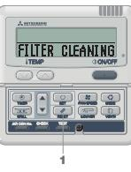
" FILTER CLEANING " wordt weergegeven Als de totale werkstijd het ingestelde aantal uren bereikt, om zodoende aan te geven dat reiniging is vereist.
